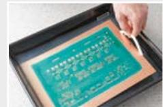
**i** Der Bestückungsdruck mit LPKF ProLegend wird nach dem exakt gleichen Verfahren mit weißem Lack hergestellt. Da gleichfalls die Bereiche belichtet werden müssen, die später farbfrei sein sollen, muss die Filmvorlage negativ bedruckt werden.
