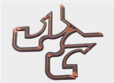
Strukturiertes und ausgeschnittenes Beispiel einer HF-Schaltung auf RO 5880 Material
