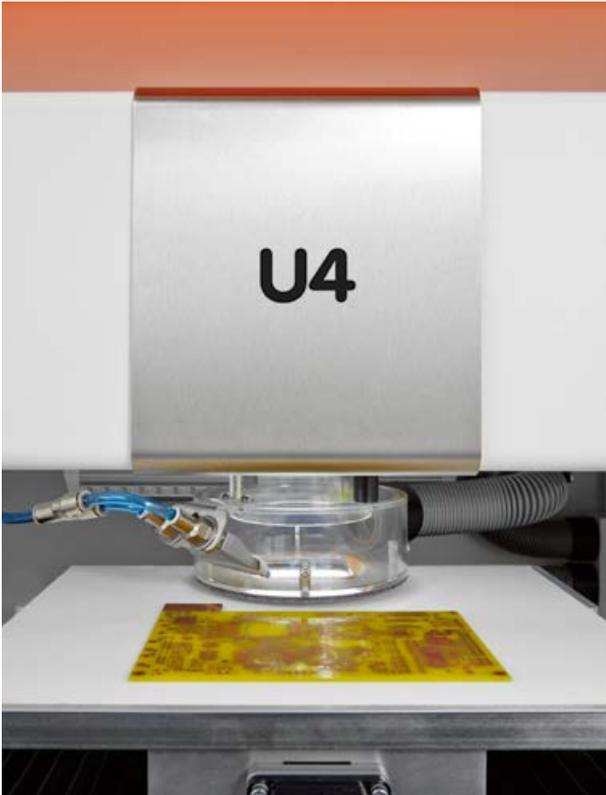
Darüber hinaus beherrscht der LPKF ProtoLaser U4 auch die Strukturierung ungewöhnlicher Materialien, z. B. von TCO-/ITO-Beschichtungen. Der exakt dosierte Laserstrahl erzeugt feinste Strukturen mit höchster Genauigkeit. Darüber hinaus öffnet der UV-Laser auch Lötstopplacke und Abdeckfolien.
