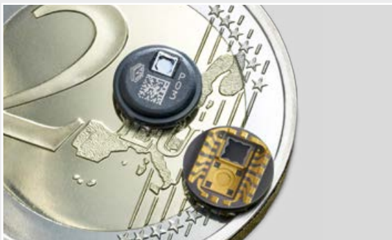
Das LDS-Gehäuse verbindet Sensor und Auswerteelektronik
