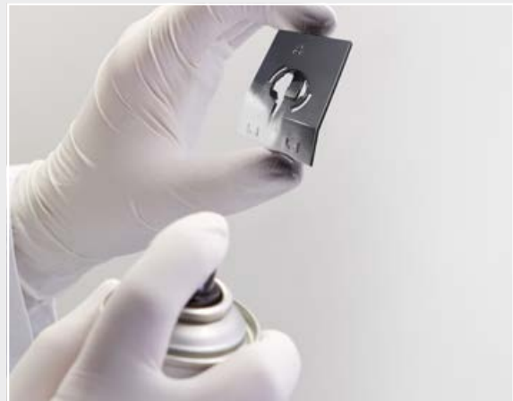
2. Lackieren des Grundkörpers mit dem Aktivatorlack LPKF ProtoPaint LDS
