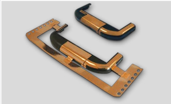
Nach kurzer chemischer Metallisierung entsteht durch klassische Galvanisierung eine glatte, bis zu 35 µm dicke Kupferschicht
