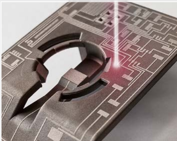
3. Strukturieren der Leiterbahnen mit dem LPKF ProtoLaser 3D
