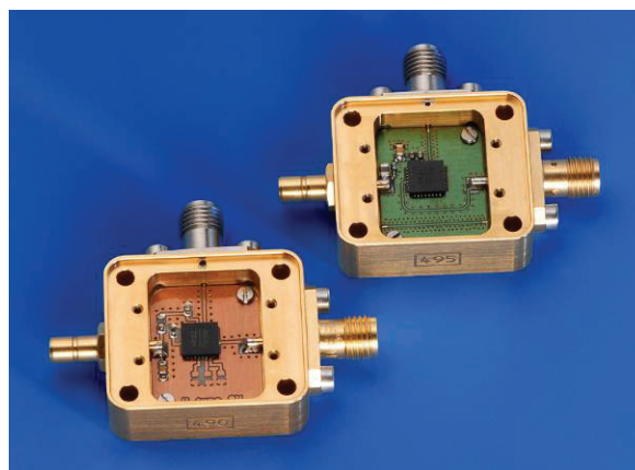
Für diesen 15 GHz-Treiberchip wurde das optimale Leiterplattenlayout experimentell mit dem LPKF ProtoLaser S ermittelt. Abgebildet sind die Testplatine (links) und das kommerzielle Endprodukt. (Foto: Fraunhofer)
